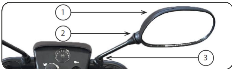
Ilustrația 3. Coloana de direcție Delta și oglinzile retrovizoare.
