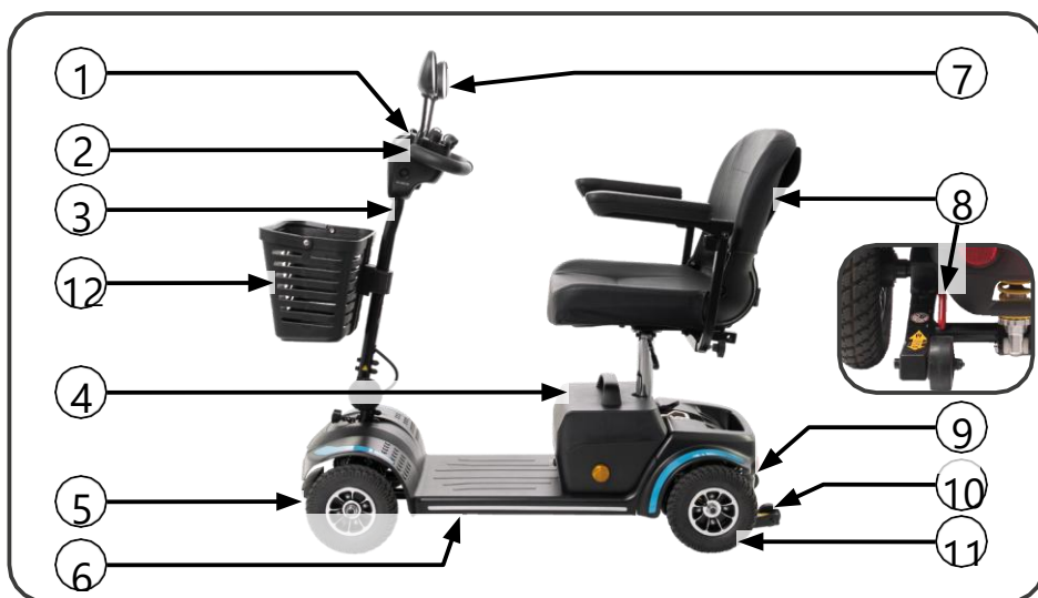
Ilustrația 1. Lista componentelor scuterului.
