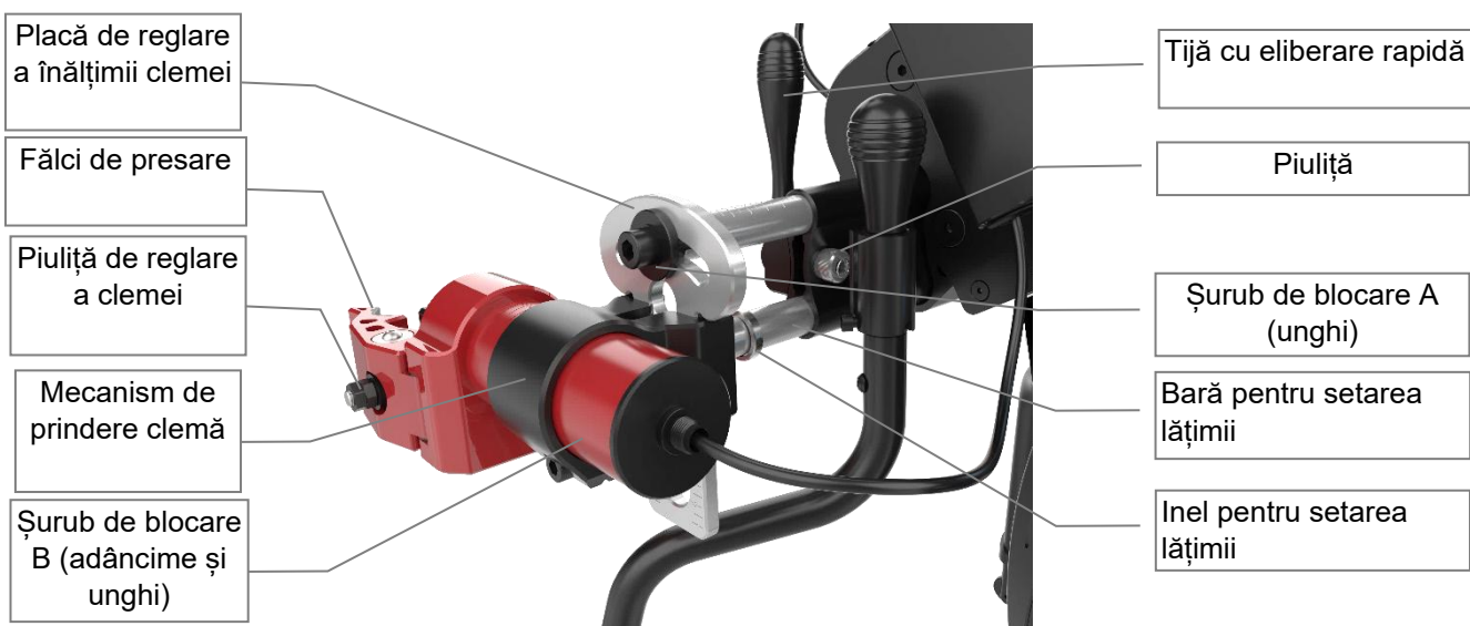
Figura 13. Unități de montare pentru sistemul automat de prindere și reglare a lățimii
