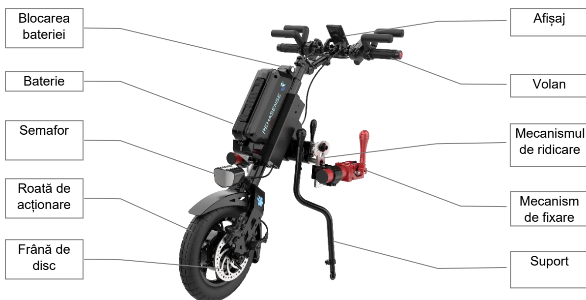
Figura 1. Componentele principale ale dispozitivului (este prezentat un exemplu de configurație manuală a clemei și cricului)
