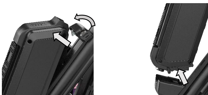
Figura 44. Demontarea și înlocuirea bateriei.
