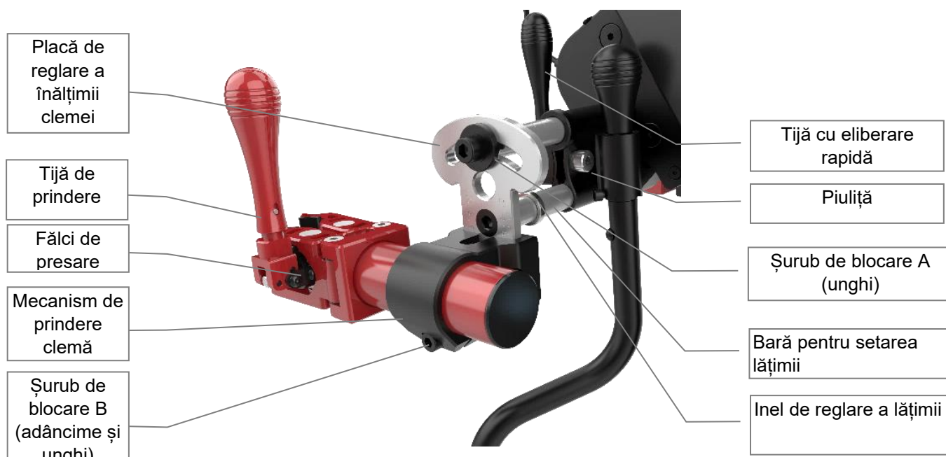
Figura 12. Unități de montare pentru sistemul manual de prindere și reglare a lățimii
